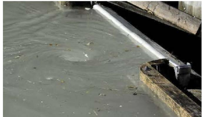
Abb. 5: Wirbelfreie Zuströmung (li.), leichte Wirbelbildung ohne Überfallströmung (re.)
